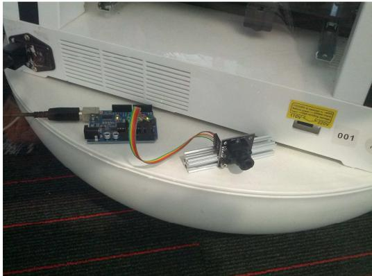
Diese Kamera filmt momentan den Gang von VoXel Interaction Design (horizontal), die Daten wandern über einen kleinen Rechner via IoT-Framework an einen Projektserver und sind via Web zugänglich. Die Plattform auf der das arbeitet ist in Javascript (Node.js) geschrieben, d.h. hier gäbe es entweder ein paar einfache Algorithmen selbst zu implementieren oder man könnte via nodejs-opencv auf OpenCV zuzugreifen.
